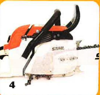
Motoren kan bare kobles inn når sagen går med lavest mulig turttall. Håndbeskytteren føres da bakover til sin utgangsposisjon. Derved frigjøres bremsebåndet fra kjededrevet og medbringerskiven føres inn i fortanningen slik at kraften kan overføres. På grunn av denne raffinerte tekniske detaljer, er det bare mulig å koble inn når kjedet står stille.
